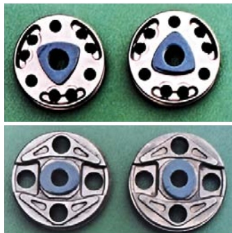
9. PODKŁADKA PROFILOWANA W PRZECIWIENSTWIE DO PŁASKIEJ MODYFIKUJE UGIĘCIE PŁYTEK ZAMYKAJĄCYCH, CZYLI SIŁĘ TŁUMIENIA PRZY DUŻYCH PRĘDKOŚCIACH TŁOKA
