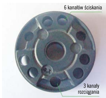
4. TŁOK AMORTYZATORA SACHS Z RÓWNOLEGŁYMI KANAŁAMI, Z KTÓRYCH TRZY ZAPEWNIJĄ PRZEPŁYW OLEJU PRZY ROZCIĄGANIU, A SZEŚĆ – PRZY ŚCISKANIU
