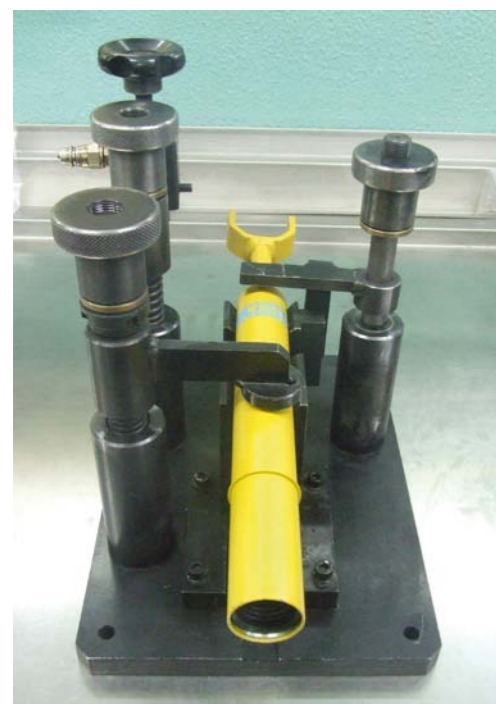
ZAMOCOWANIE KORPUSU AMORTYZATORA W UCHWYCIE NAPEŁNIACZA
