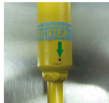
DODATKOWY OTWÓR DO USUNIĘCIA AZOTU, JEGO ŚREDNICĘ 2 MM ZWIĘKSZA SIĘ PÓŹNIEJ DO 4 MM
