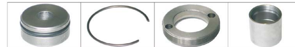
ELEMENTY NIEZBĘDNE DO PRZERÓBKI AMORTYZATORA NIEROZBIERALNEGO NA ROZBIERALNY
