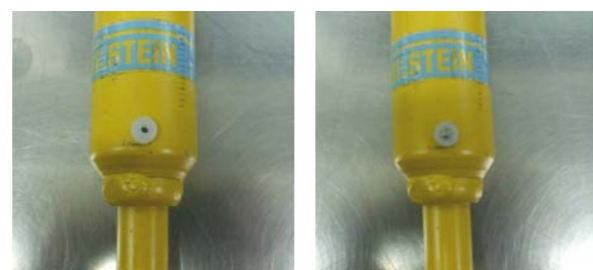
TULEJKA W OTWORZE O ŚREDNICY 4 MM (Z LEWEJ) I KOŁEK WCIŚNIĘTY W TULEJKĘ
