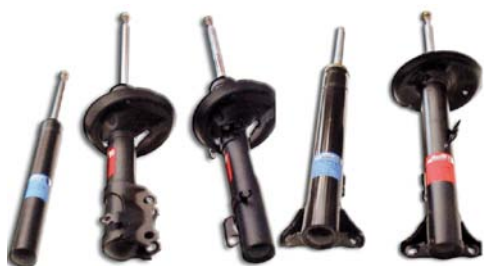
RÓŻNE WARIANTY MOCOWANIA KOLUMNY MCPHERSONA W ZAWIESZENIACH SAMOCHODOWYCH
