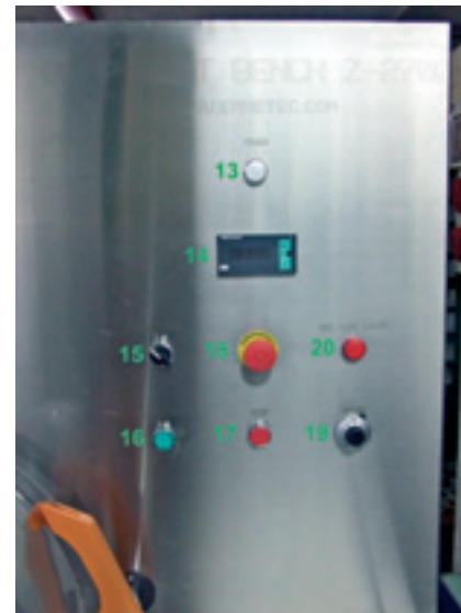
14. Prawa część stołu z kontrolkami i przyciskami do włączania, wyłączania i regulacji.
