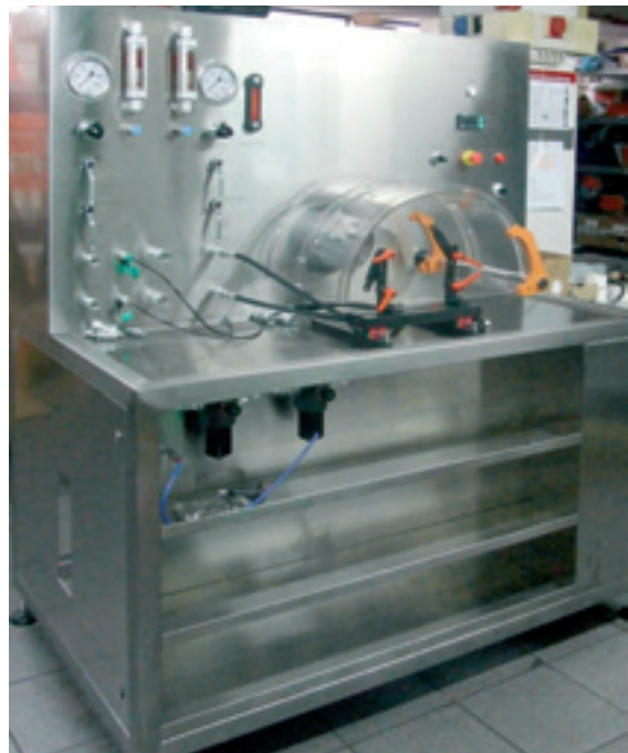
11. Stół testowy do badania pomp Emmetec Z-27002 zbudowany ze stali nierdzewnej, łatwy w utrzymaniu w czystości, piękny i ponadczasowy.
