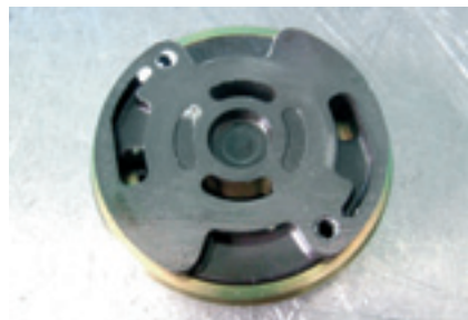
5. Po zdjęciu pierścienia blokującego zdejmujemy pokrywę, która stanowi całość z górną płytkę oporową (widok od spodu).
