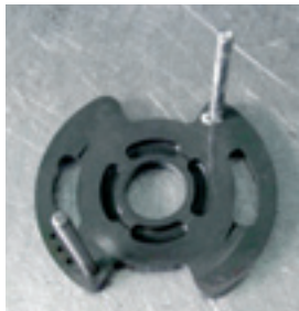
8. Dolna płytka oporowa ze szpilkami mocującymi.
