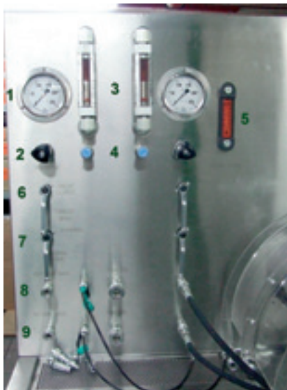
12. Lewa część stołu testowego Z-27002, ze wskaźnikami i kontrolkami do obsługi pompy podczas testu.
