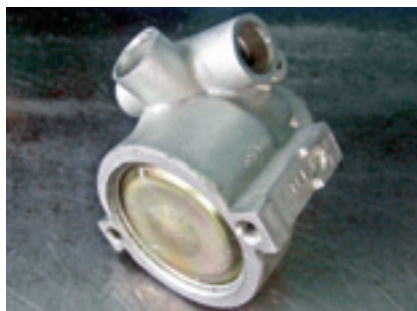
2. Pompa LUK 2607 9079 – prosty model idealnie nadający się do nauki regeneracji.
