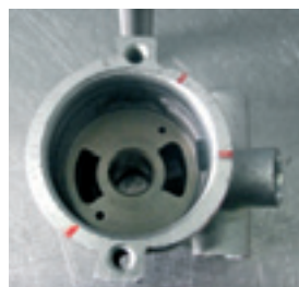
10. Korpus pompy zupełnie pusty – musi być kompletnie wyczyszczony z jakiegokolwiek brudu, szczególnie z opiłków metali.
