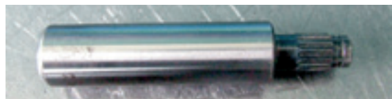
9. Wałek obrotowy pompy – powinien być wypolerowany papierem ściernym na tokarce, szczególnie w miejscu mocowania uszczelniaacza.
