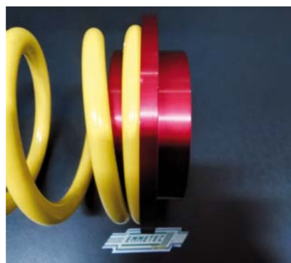
RYS. 3. PROWADNICA MUSI ŚCIŚLE PRZYLEGAĆ DO SPRĘŻYNY NA DŁUGOŚCI 10-15 MM
