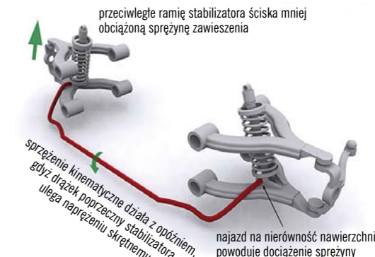
RYS. 18. DZIAŁANIE STABILIZATORA OGRANICZAJĄCE PRZECHYLEŃ NA ZAKRĘTACH
