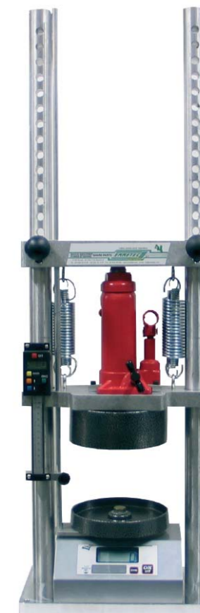
RYS. 9. STÓL EMMETEC 99-966 DO ELEKTRONICZNEGO BADANIA CHARAKTERYSTYK SPRĘŻYN
