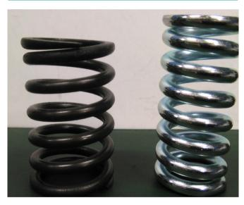
**61** Molas de ressalto: uma nos amortecedores com um curso longo, especialmente se no eixo dianteiro, pode aumentar o conforto; nos amortecedores curtos de corrida pode ser montada sobreposta em várias séries, reduzindo o balanço.
