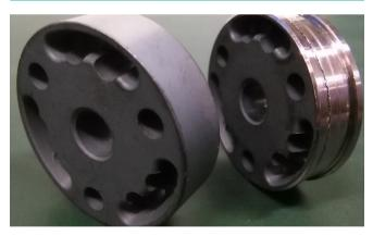
**62** O pistão da EMMETEC em bruto pode ser maquinado de forma a adequar-se a qualquer anel de PTFE, incluindo um o-ring interior que pressiona contra o de PTFE.
