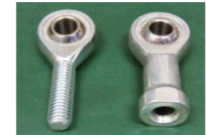
RYS. 10. KOŃCÓWKI WYPUKŁE I WKŁĘSŁE EMMETEC: PRZYKRĘCAJĄC JE LUB ODKRĘCAJĄC NA KORPUSIE AMORTYZATORA LUB NA KOŃCU TRZPIENIA, ZMIENIA SIĘ DŁUGOŚĆ AMORTYZATORA, WSTĘPNY ZAŁADUNEK ELEMENTU ELASTYCZNEGO ORAZ PUŁAP SKOKU W ODBICIU RACZEJ NIŻ W DOBICIU
