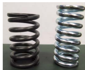
RYS. 5. SPRĘŻYNY OGRANICZAJĄCE SKOK AMORTYZATORA MOŻNA MONTOWAĆ W RÓŻNYCH KOMBINACJACH DLA POPRAWY KOMFORTU LUB STABILNOŚCI JAZDY
