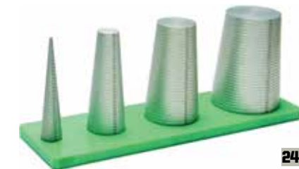
Medidor de calibre Z-11000. Para medir o diâmetro de um o-ring ou de um segmento de teflon basta metê-lo num cone e empurrá-lo até parar. Neste caso um só instrumento substitui dezenas, fazendo uma medição rápida e exata
