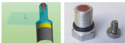
RYS. 6. GWINTOWANA ZAŚLEPKA Z SILIKONOWĄ ZATYCZKĄ DAJE MOŻLIWOŚĆ ZWIĘKSZENIA CIŚNIENIA AZOTU PRZEZ JEGO POMPOWANIE ZA POMOCĄ DRAŻONEJ IGŁY PRZEKŁUWAJĄCEJ SILIKON
