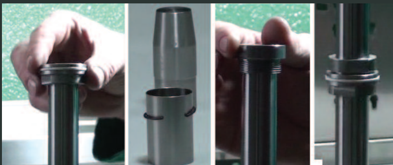
Τα πιστόνια EMMETEC KS απλοποιούν τη διαδικασία: στην ουσία είναι δύο κομμάτια με δύο συνεργαζόμενα σπειρώματα και δεν απαιτούν τους προηγούμενους δίσκους
